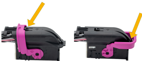
Obrázek: Konektor V3 v odjištěné poloze (i přes cvaknutí NENÍ správně zapojený) vs. konektor V3 v zajištěné poloze (vpravo).
